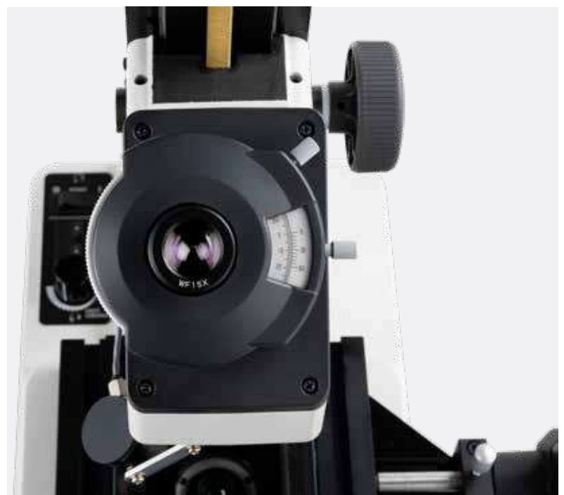
Vernierova stupnice umístěná vně okuláru umožňuje jednoduché měření úhlů.
