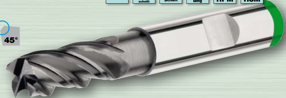
175487 VHM-Schaftfräser mit Fase und freigeschliffenem Schaft
